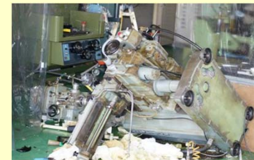
転倒、破損した研究設備 (東北大学)
